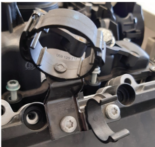
18. ábra: Kábelkötegtartó belső égésű motoron és vízcsőtartó 3D-modellje üvegszál erősítéssel
