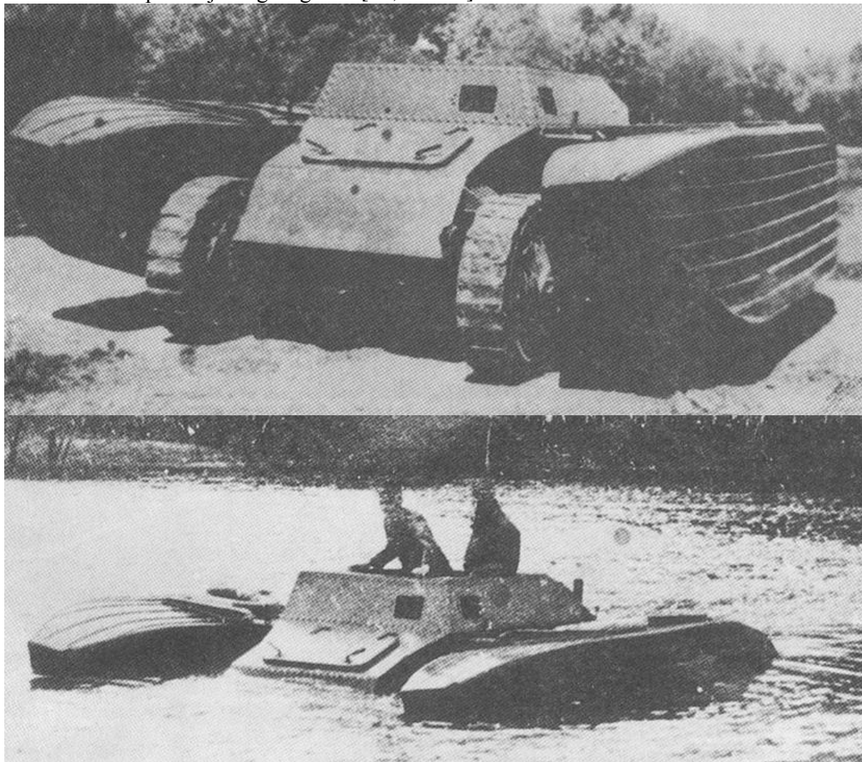
10. ábra: A V-3 felcsatolt pontonokkal a szárazföldön, illetve úszópróba közben. [17; 26. o.]
