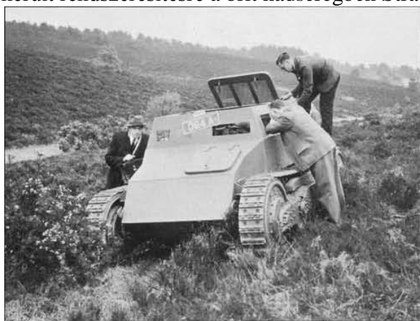
17. ábra: A magyar V-3-hoz képest pár apróbb módosításon átesett 21 Straussler Light Tank tesztelés közben Angliában, 1936-ban. [10; 41. o.]
