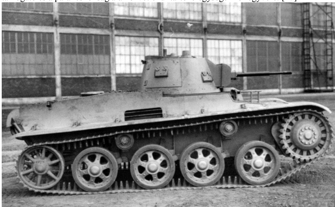
12. ábra: A Landsverk L-60 magyar próbákon is használt változata. Bár fegyverzete gyengébb volt, mint magyar riválisáé, modern, torziós rugós felfüggesztése és döntött páncélzata jóval korszerűbb konstrukciójává tette annál. [28]
