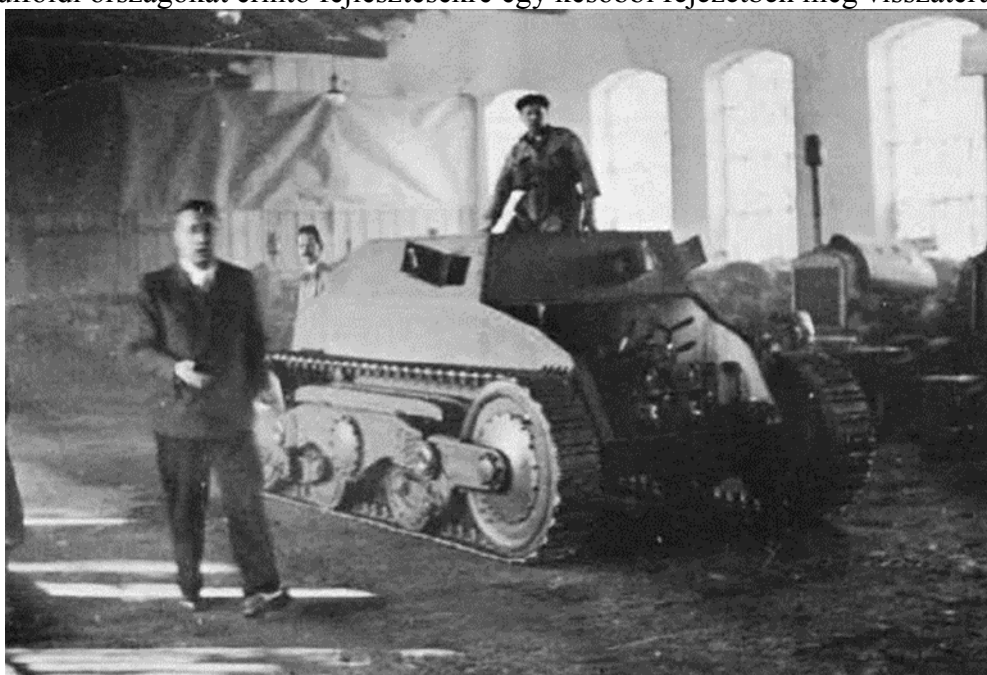
9. ábra : A V-3 prototípusa a csepeli Weiss Manfréd Acél- és Fémművek szerelőműhelyében. [10; 40. o.]
